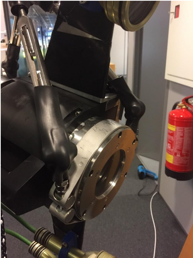
Figur 3: Skarpe kanter og skruer er belagt med krympestrømpe
